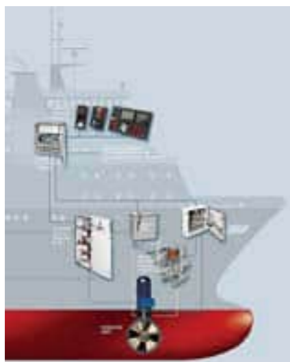
STORE FORHOLD: Det er ikke småmaskiner vi snakker om ved leveranser av drevsatser til båter. Drevsatsen sitter mellom drivakselen fra motoren og drivakselen til propellen, og sørger for at kraften fra motoren driver propellen rundt.
