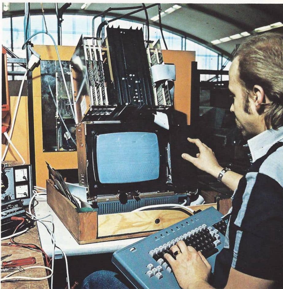
Produksjonen av Siemens-terminalene på Tandberg er preget av en nitid kontroll, og operatørene har avanserte måleinstrumenter til rådighet i arbeidet. Bildet er fra en av arbeidsplassene på Kjelsås, og viser Sigbjørn Vigeland i aktivitet.
