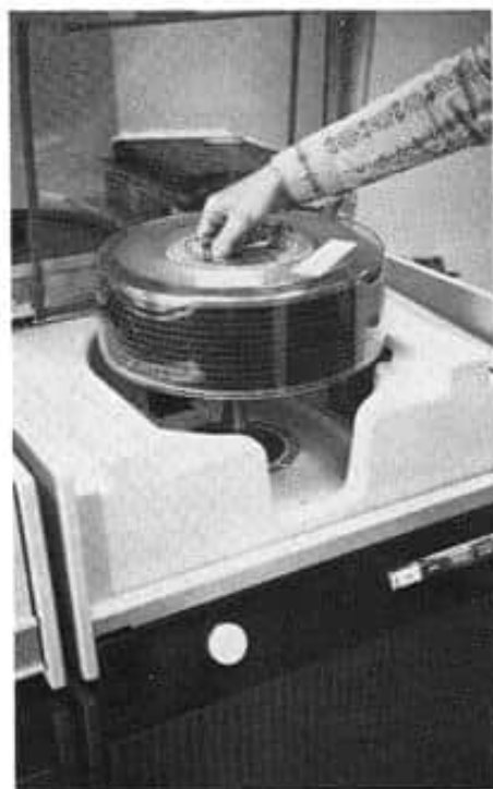
Her løftes "disc'en" opp av en magnetplatesta- sjon. Data over våre ca. 8000 faste kunder (navn, adresse, kontonummer, rabatter osv. - tilsammen 30 forskjellige opplysninger pr. kunde) belegger bare en fjerdedel av en slik "disc".
