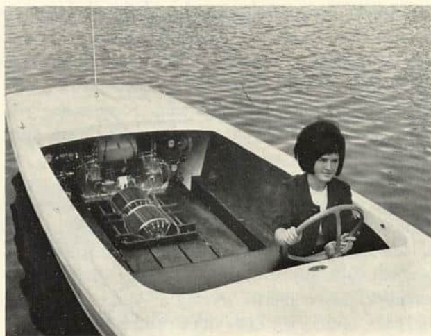
Fig. 4. Med 7 km i timen og med 5 personer ombord kan denne båten kjøre. Egentlig ikke noe sensasjonelt, men båten blir drevet frem med en fullstendig ny driftstart: Brennstoffceller mater båtens elektromotor med elektrisk energi. Disse brennstoffceller, som nå er driftsferdig utviklet i det nye Siemens Forskningscenter i Erlangen, lager ikke noe stinkende, skadelige ekshaustgasser, men istedenfor et stoff som ikke kan skade noen: det reneste vann.
